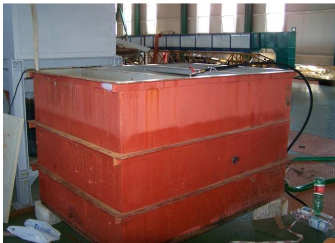
Figura 39 – Cassone in acciaio da 3000 l utilizzato per il caricamento dell'acqua nell'apparato sperimentale
