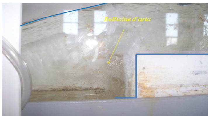
Figura 52 – Particolare dell'ingresso delle bolle d'aria
