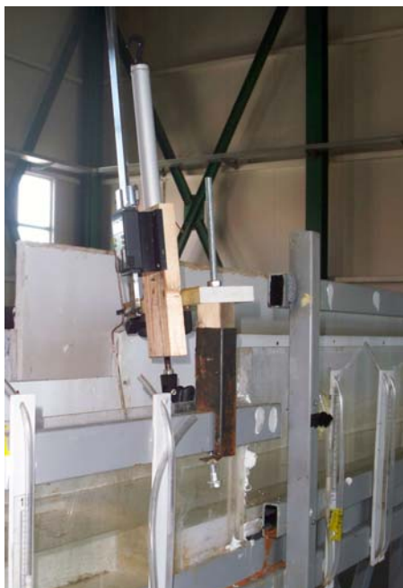
Figura 45 – Punta idrometrica con misuratore digitale
