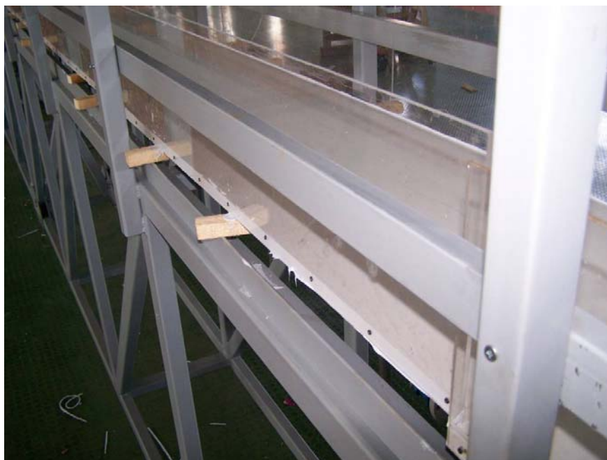
Figura 28 – Sostegno delle sponde
