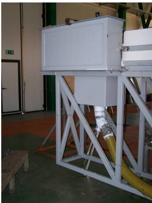
Figura 32 – Cassone di monte con il collegamento del pozzetto alla condotta di mandata
