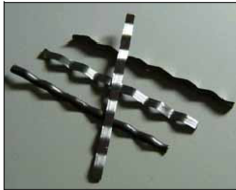
Fig. 4.4.3 - Fibre d'acciaio a lamina deformata
