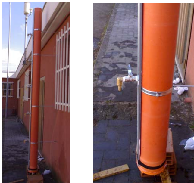
Figura 9.4 – Installazione sperimentale per la misura in colonna di sedimentazione
