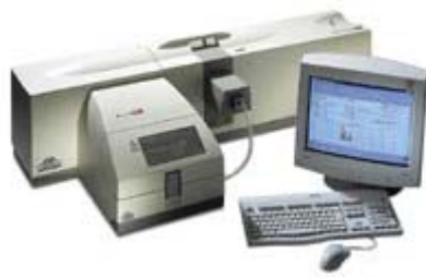
Figura 7.6- Esempio di diffrattore laser tipo Malvern 3600D
