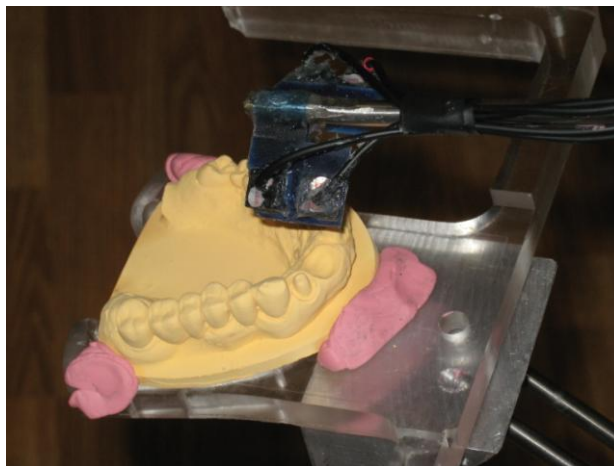
Fig. 5.20: Posizionamento del modello di arcata dentale sulla mascherina di fissaggio
