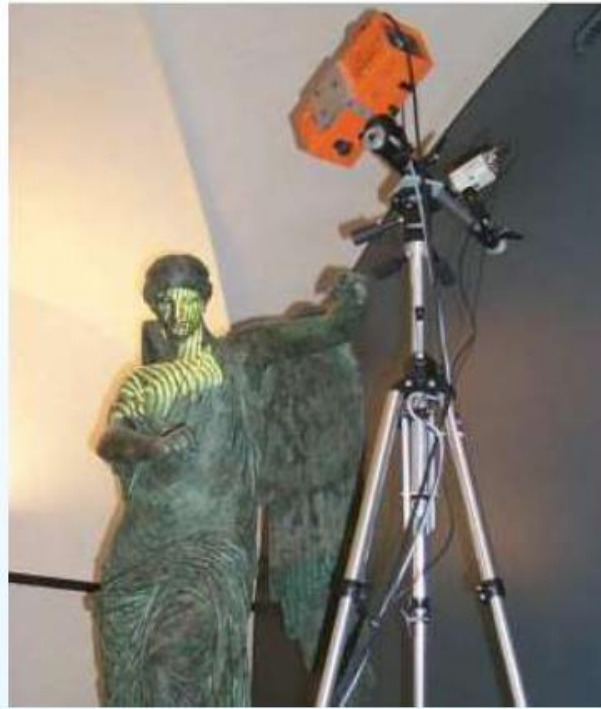
Fig.1.10 Proiezione di un reticolo su un oggetto. Il reticolo viene deformato dalla geometria dell'oggetto
