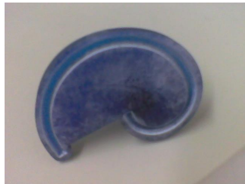
Fig. 5.39: Seconda camma costruita con la macchina per rapid prototyping
