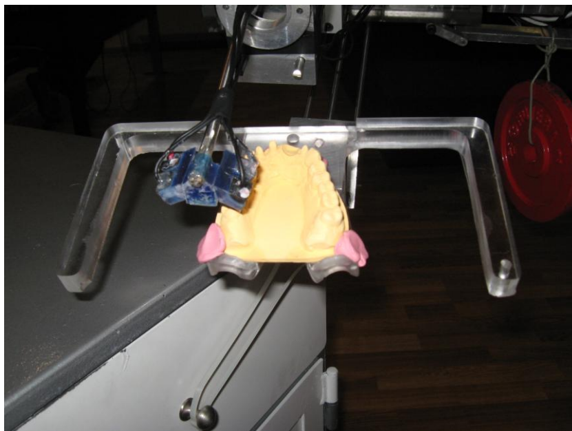
Fig. 5.34: Fase di scansione ottimale: la testina inizia con la scansione degli incisivi per poi proseguire con la scansione di una parte di arcata, ritornare sugli incisivi e per finire con l'altra parte di arcata
