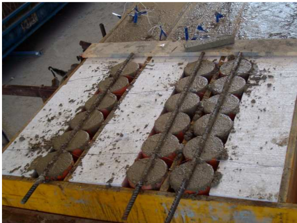
Figura 4.13: Preparazione dei provini di cls
