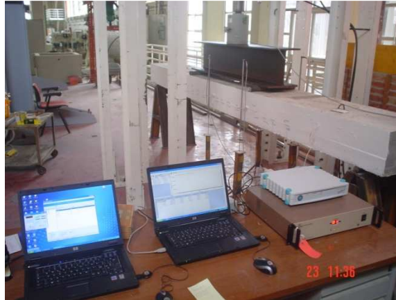
Figura 2.4: Prova a flessione su trave PREM
