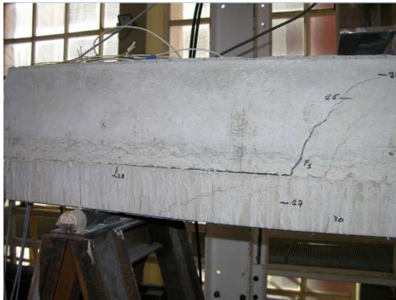
Figura 4.117: Trave C.02 a rottura
