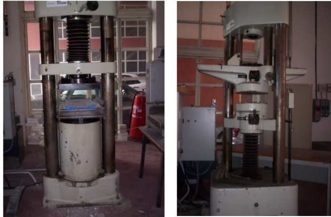
Figura 2.7: Pressa oleodinamica e macchina per la prova a trazione delle barre di acciaio
