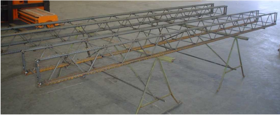
Figura 2.1: Traliccio travi PREM sottoposte a prova
