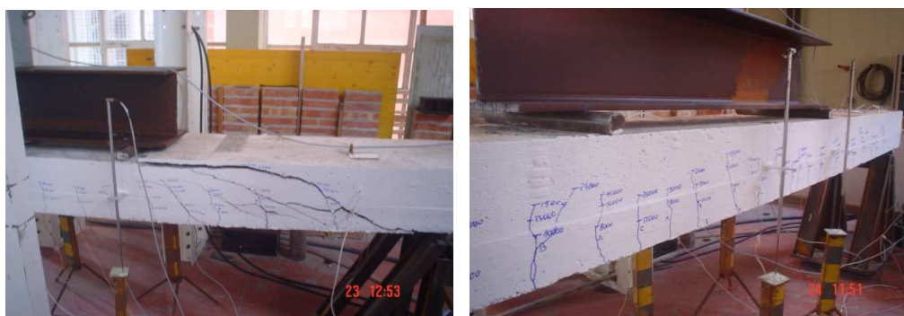
Figura 2.16: Foto modo di collasso trave n°01 e quadro fessurativo trave n°02
