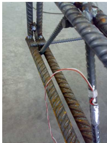
Figura 2.5: Estensimetro E2 applicato sulla greca
