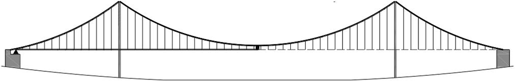
Figura 3.11: Ponte sospeso con incastro centrale e appoggio fisso sull'ancoraggio
