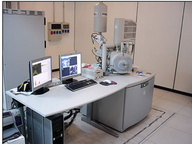
Figura 2.20. Microscopio elettronico Field Emission Gun (FEG) Quanta 200F della FEI/Philips.
