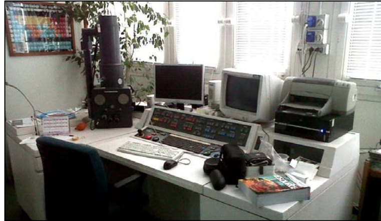
Figura 2.23. Apparato di Catodoluminescenza; SEM Cambridge Stereoscan 360 connesso ad uno spettrometro Horiba Jobin Yvon VS140 UV-VIS con una risoluzione spaziale di \sim 1 nm.
