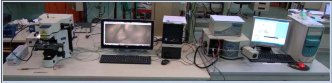
Figura 2.24. Microscopio Olympus Horiba Jobin Yvon. Spettrometro Triax 320 Horiba Jobin Yvon (range di 200 – 1500 nm)
