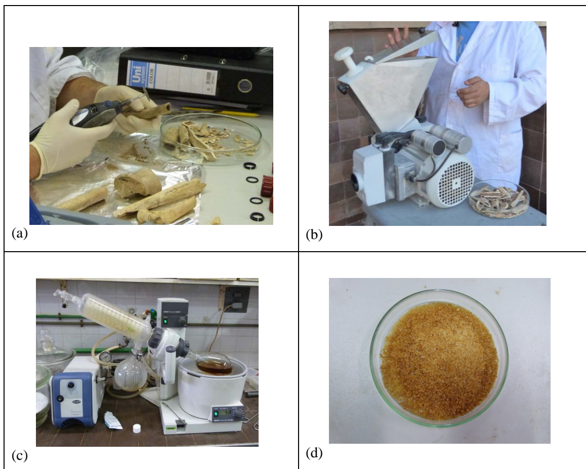
Figura 4.1. Fasi di preparazione del materiale per l'ottenimento della gelatina: (a) pulitura superficiale mediante bisturi; (b) macinazione e riduzione in polvere con l'uso di un mulino; (c) rotovaporatore per l'essiccamento della gelatina; (d) gelatina ottenuta
