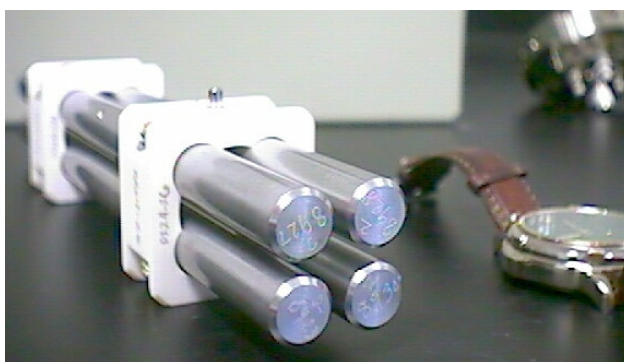
Figura 35 Bacchette del quadrupolo dello spettrometro di massa.
