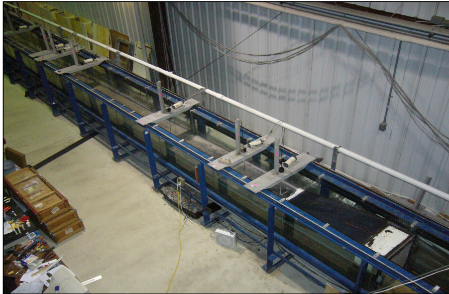
Figura 3.3: Disposizione delle sonde G1-G7 in canaletta
