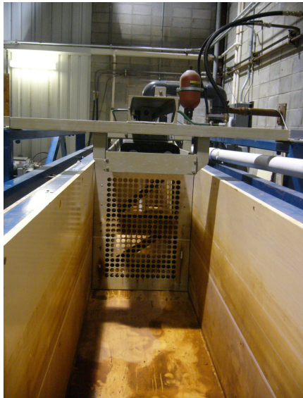
Figura 3.8: Generatore di onde irregolari utilizzato durante gli esperimenti
