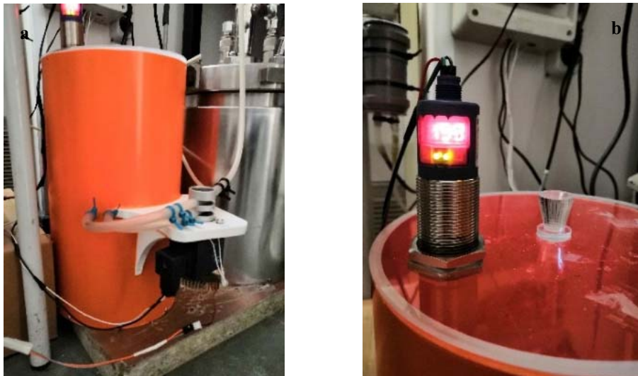
Figura 7.12. a) Vista del sistema di misura del biogas. b) Particolare del sensore di misura.
