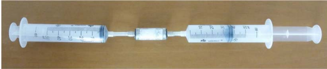
Figura 7.16. Sistema di misura della percentuale di biometano contenuta nel biogas.
