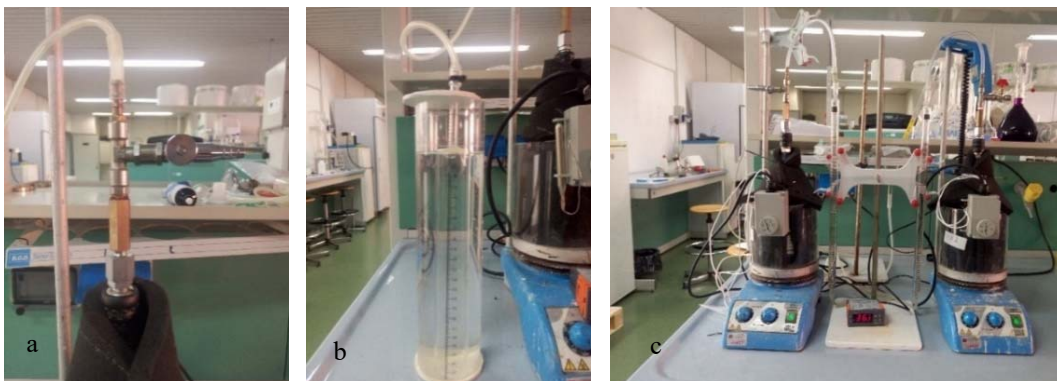
Figura 7.6. a) Particolare dell'alloggiamento di testa del reattore. b) Sistema di misura volumetrica del biogas prodotto. c) Due degli nove reattori batch utilizzati nelle sperimentazioni per le biomasse agroindustriali e della FORSU.
