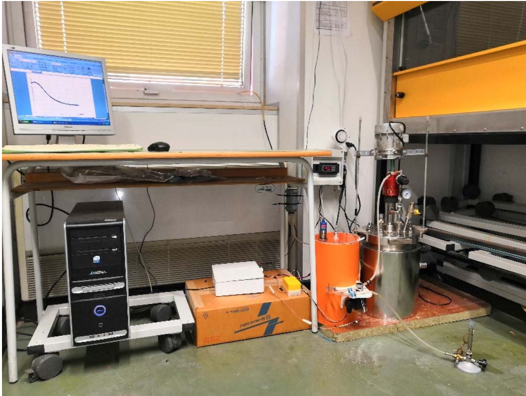
Figura 7.15. Foto dell'impianto CSTR realizzato e funzionante. Dalla foto si nota in particolare un becco bunsen utilizzato come torcia per bruciare il biogas prodotto, il PC utilizzato per la visualizzazione dei dati e il sistema di misura ed acquisizione del biogas.
