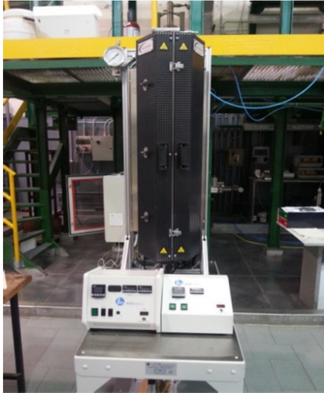
Figura 7.20. Reattore Parr Instrument Co.®, Moline, IL., utilizzato per i test di gassificazione in condizioni supercritiche dei digestati dei Mix-1 e Mix-2.
