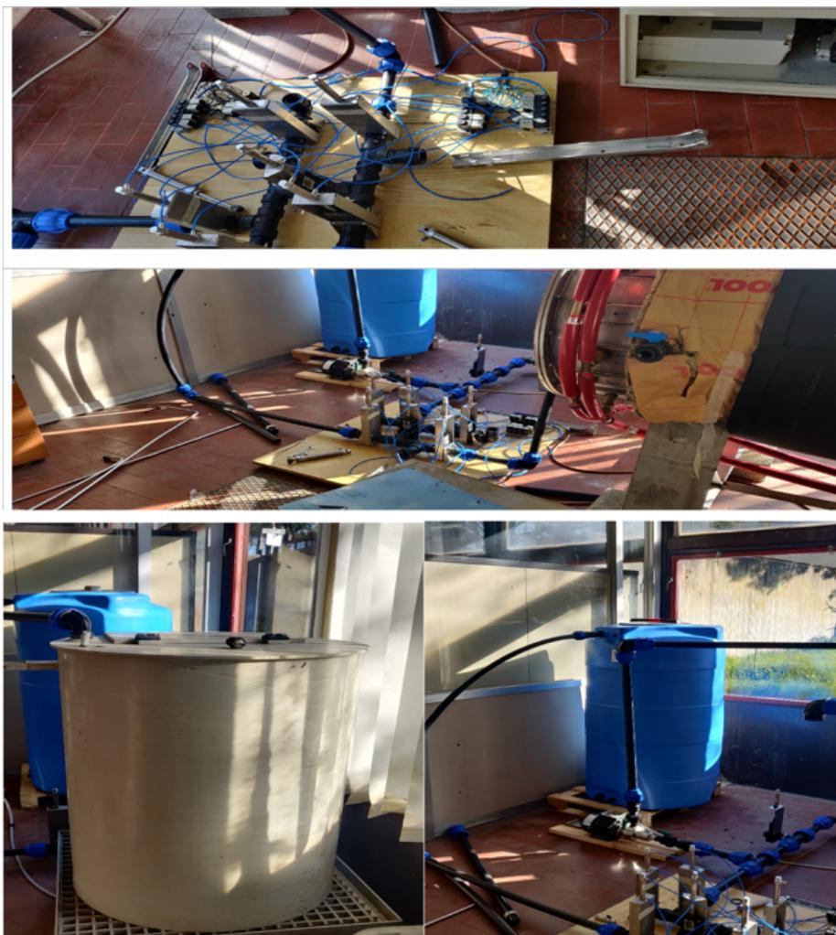
Figura 28 - Sistema di alimentazione e prelievo, vasca di alimentazione e di stoccaggio del digestato
