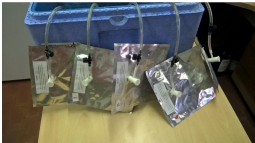
Figura 17 - Sacche di campionamento del biogas
