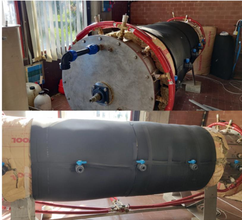
Figura 25 - Sistema di riscaldamento e di coibentazione
