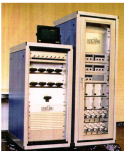
Fig. II.1.10.1- Analizzatore gas d scarico
