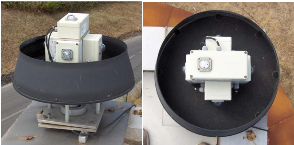
Fig 2.1 – Strumento per la misura dell'illuminamento sulla sup. orizzontale e sulle 4 sup. verticali esposte a nord, sud, est e ovest.
