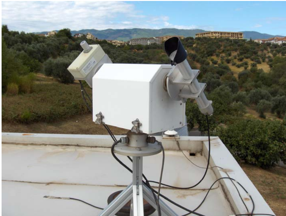
Fig 2.2 – Inseguitore Solare per la misura dell'Illuminamento e dell'Irraggiamento diretti.
