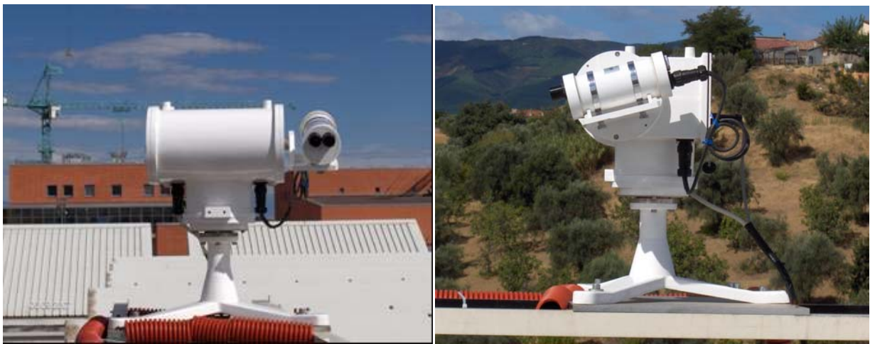
Fig. 2.5 - Sky scanner con sensori per la misura della luminanza e della radianza della volta celeste.
