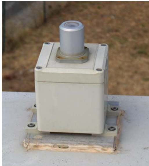
Fig 2.4 – Strumento per la misura della Luminanza Zenitale.
