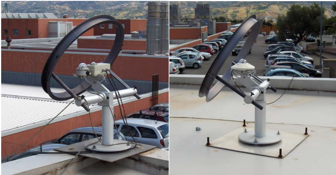
Fig 2.3 – Strumenti per la misura dell'illuminamento e dell'irraggiamento diffusi.
