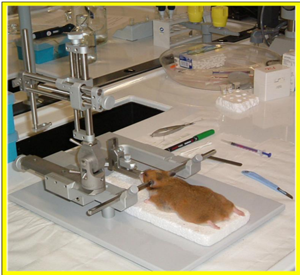
Fig. 15 Strumento stereotassico adatto al trattamento di roditori da laboratorio
