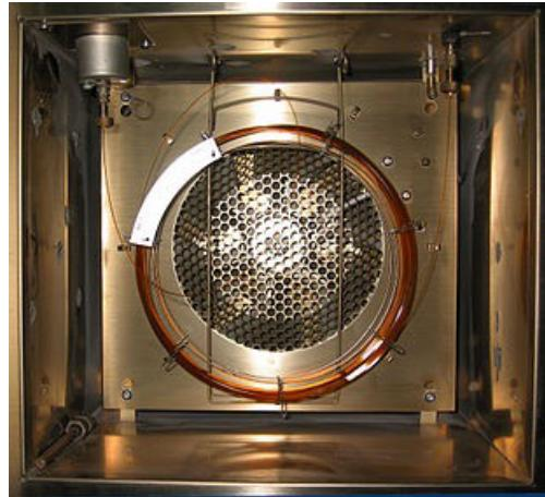
figura 3A.10: *Fotografia del particolare interno del GC: colonna capillare utilizzata*
