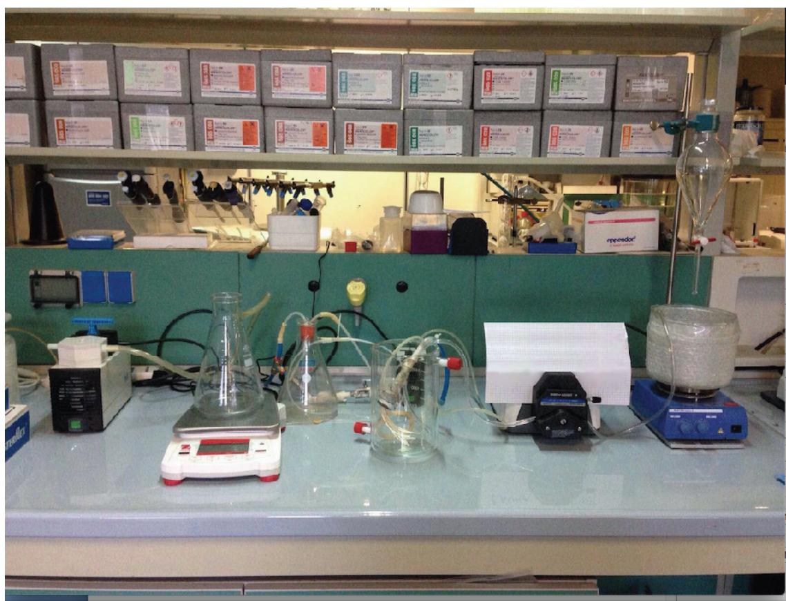
*figura 3.7: Installazione di laboratorio con MBR per il trattamento di acque reflue civili e meteoriche*
