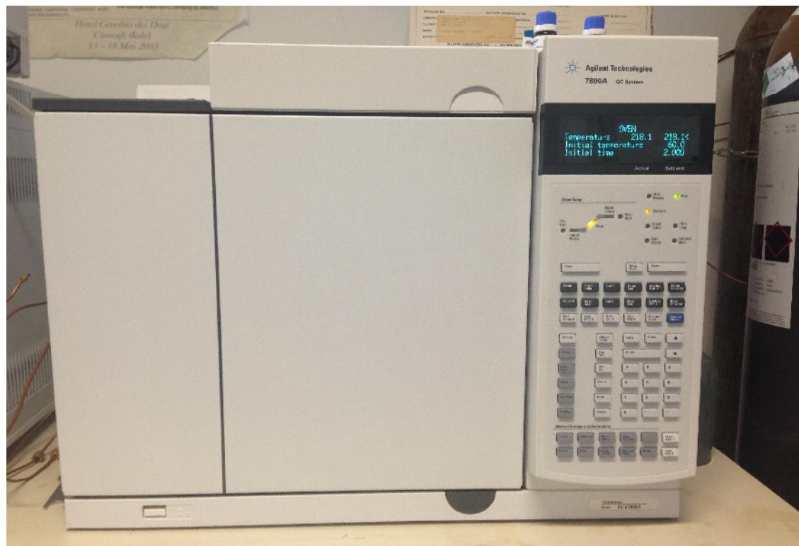
figura 3A.9: Fotografia del Gas Cromatografo
