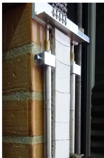
Figura 3.8 – B4-FRCM: scorrimento all'estremità caricata L_b = 400 mm
