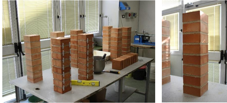
Figura 2.25 – Test di taglio diretto: realizzazione supporti in muratura
