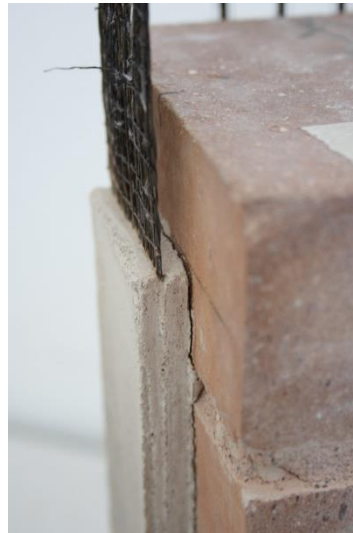
Figura 3.43 – S-FRCM: delaminazione all'interfaccia post trattamento a 500 °C
