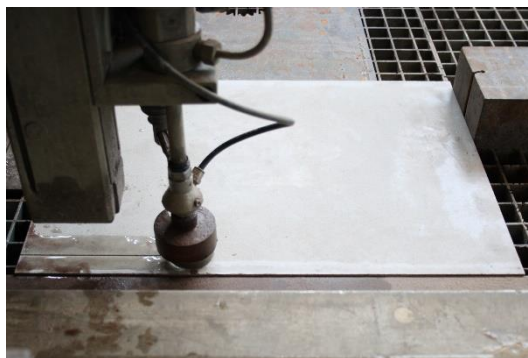
Figura 2.23 – Operazioni di taglio mediante water-jet
