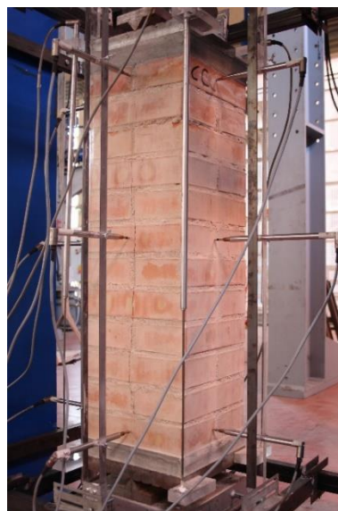
Figura 3.53 – Colonna non confinata a rottura
