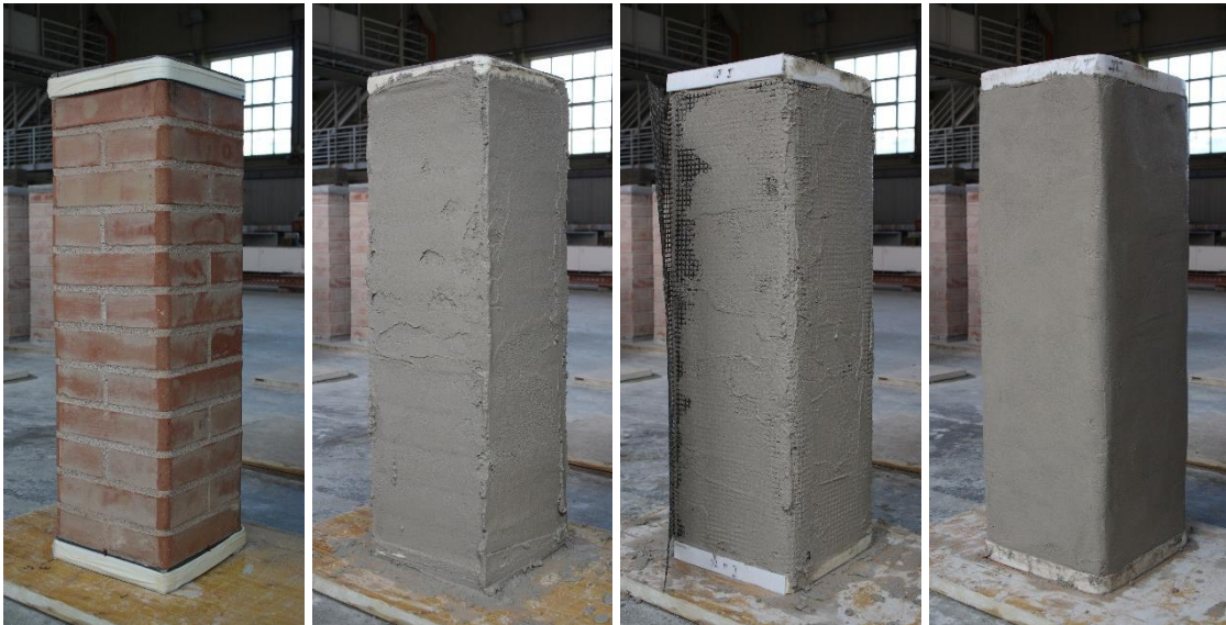
Figura 2.33 – Confinamento con rinforzo in fibra di basalto
