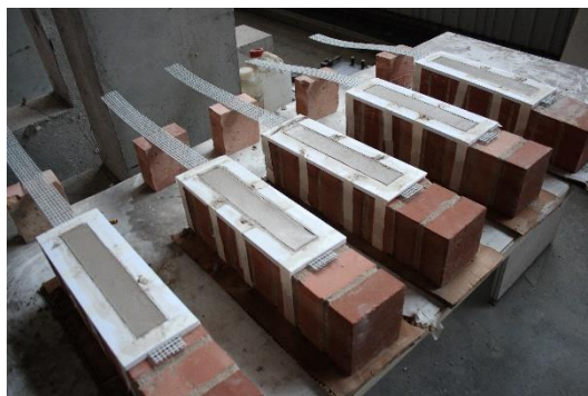
Figura 2.29 – Preparazione dei campioni del sistema di rinforzo in acciaio
