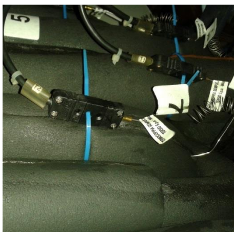
Figura 6.9 – Termocoppie a contatto di tipo K lato refrigerante e a immersione di tipo J lato acqua.
