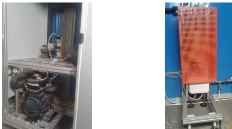
Figura 4.2 - Gruppo Frigorifero e generatore di vapore del calorimetro
