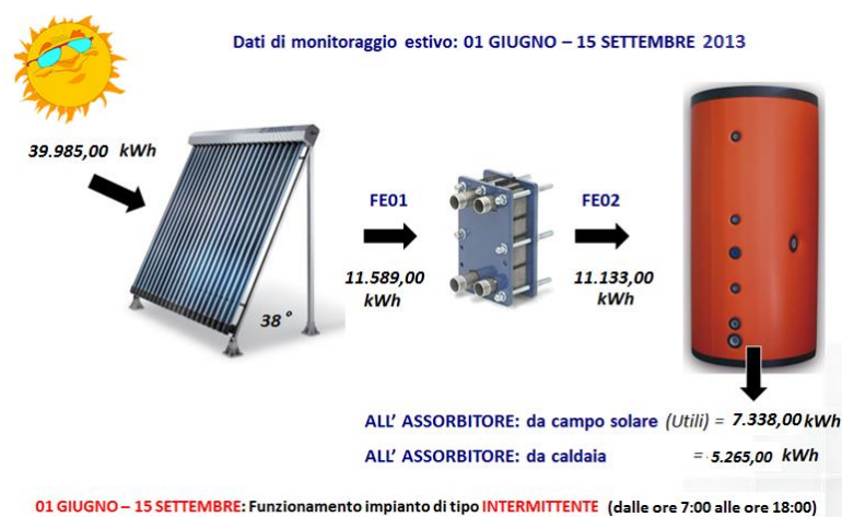
Figura 5.139 - Schema produzione e fornitura energia a partire dai collettori solari (estate 2013).
