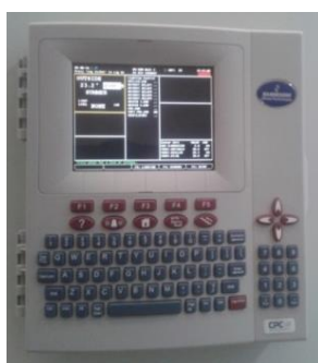
Figura 4.9 - Computer industriale sistema BMS.
