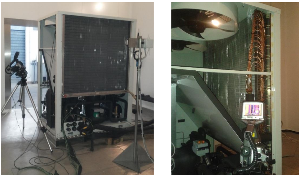
Figura 6.6 – Evaporatore e fase di test in camera climatica con termo camera.
