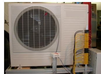
Figura 7.13 - Pompa di calore a CO 2 .
