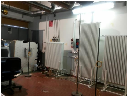
Figura 7.12 - Facility di prova con pompa di calore a CO 2 abbinata a radiatori a elevato salto termico.
