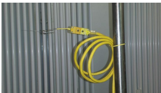
Figura 7.21 - Termocoppia utilizzata per il monitoraggio della temperatura ambiente in prossimità di un radiatore.
