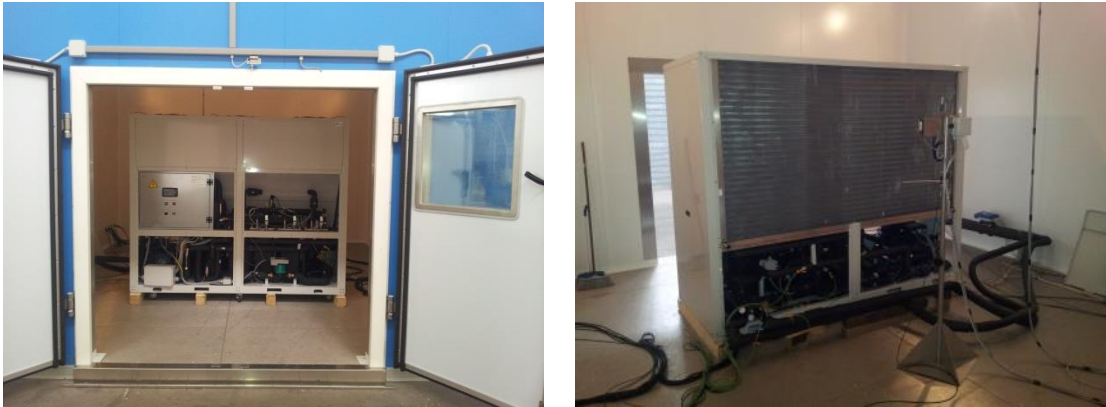
Figura 6.48 – Prototipo da 50 kW in fase in camera climatica.
