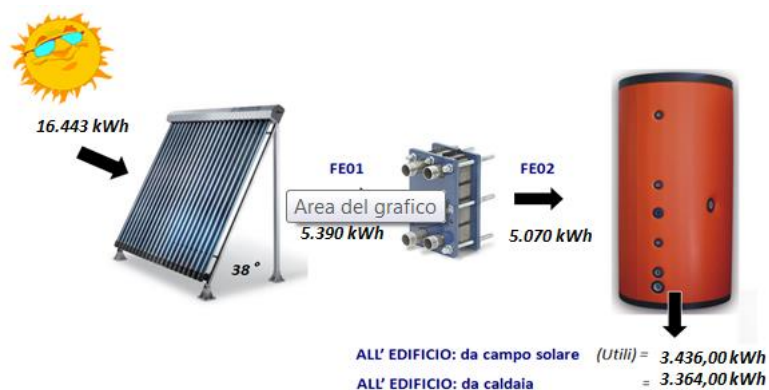
Figura 5.31 - Schema produzione e fornitura energia a partire dai collettori solari durante il monitoraggio invernale 2012.
