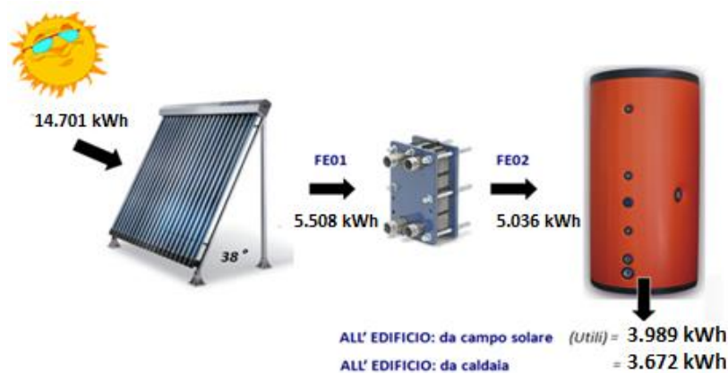
Figura 5.56 - Schema produzione e fornitura energia a partire dai collettori solari durante il monitoraggio invernale 2013.
