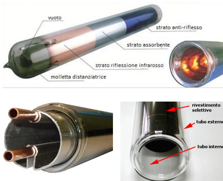
Figura 2.12 - Struttura collettori solare a tubi evacuati sottovuoto.
