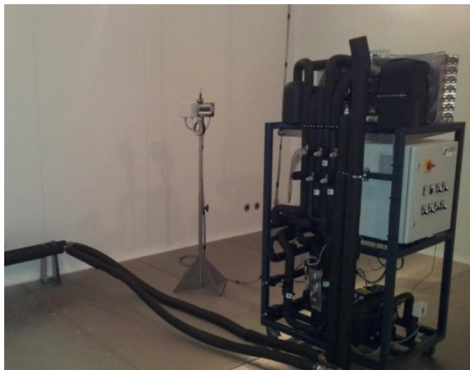
Figura 4.4 - Piedistallo per il posizionamento delle sonde di temperatura e di umidità all'interno del calorimetro.
