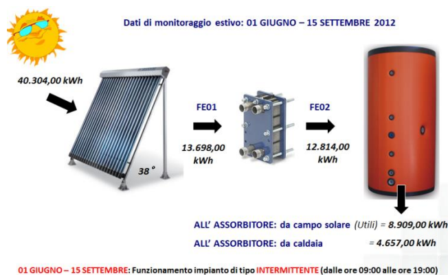
Figura 5.91 - Schema produzione e fornitura energia a partire dai collettori solari estate 2012.
