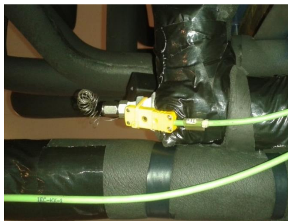
Figura 6.9 – Termocoppie a contatto di tipo K lato refrigerante e a immersione di tipo J lato acqua.
