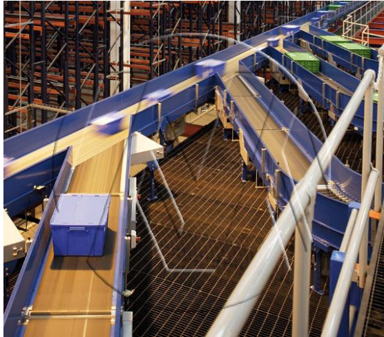
Figura 2.20: Magazzino a carosello (Foto Gruppo Mecalux Italia)
