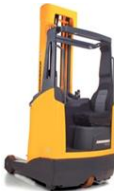
Figura 3.26 Carrello retrattile(Foto Jungheinrich)
