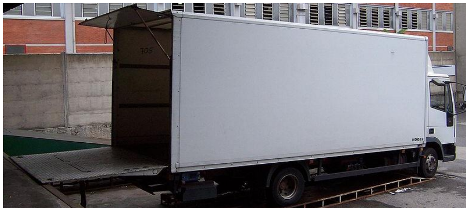
Figura 3.15 Autocarro munito di sponda montacarichi posteriore
