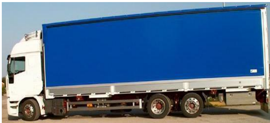
Figura 3.13 Autocarro con centinatura per il trasporto di elevati carichi di merce
