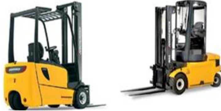
Figura 3.25 Carrello elevatore a razze portanti (Foto Jungheinrich)
