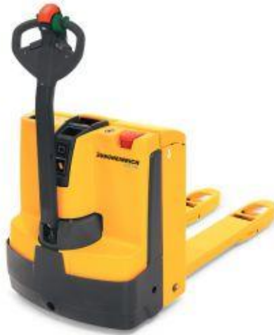
Figura 3.22 Carrello transpallet elettrico con operatore su piattaforma (Foto Jungheinrich)
