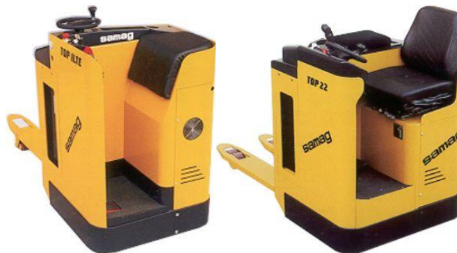
Figura 3.23 Carrello transpallet elettrico con operatore a bordo (Foto Samag)
