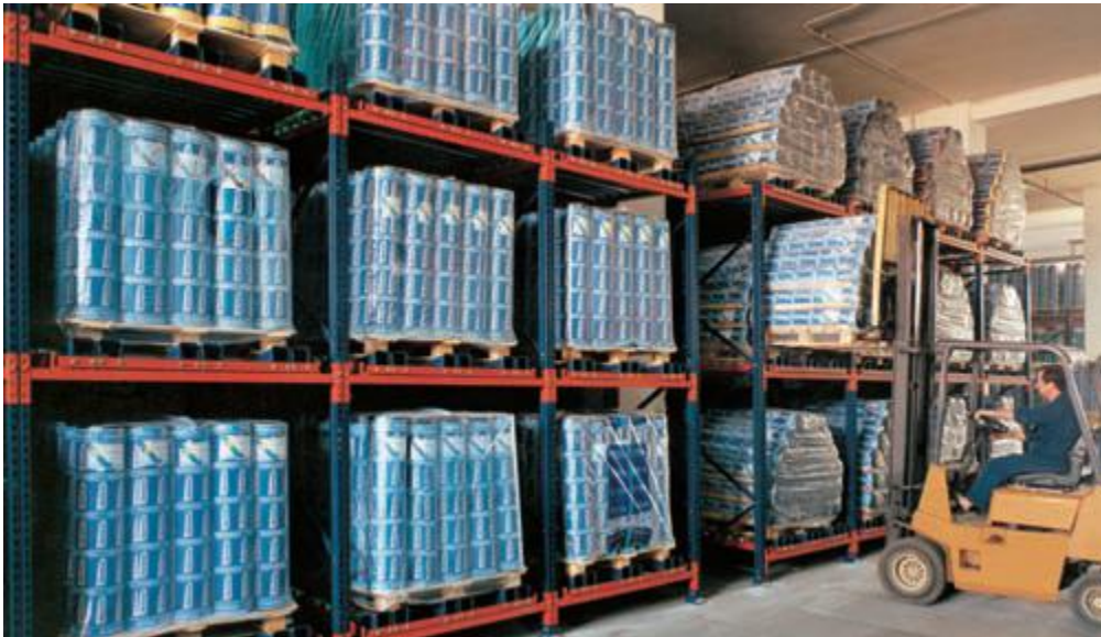
Figura 2.19 Magazzini dinamici con canali in contropendenza. (Foto Gruppo Mecalux Italia)
