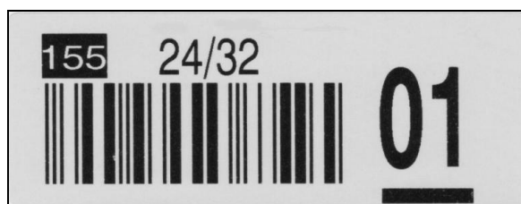
Figura 4.22 Etichetta che evidenzia la posizione di picking, in alto a sinistra su sfondo nero presente il CheckSum Code
